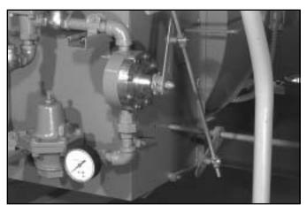
1. ADJUST THE LINKAGE TOWARD THE DRIVE SHAFT FOR LESS MOVEMENT.
