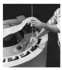
FIGURE 8 - WIRE BRUSHING THE FLUE PASSAGES
